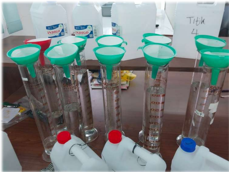
Gambar 17. Pengukuran sedimen tersuspensi di aliran sungai
