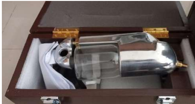
Gambar 9. Foto instrumen water sampler / suspended sediment sampler untuk sampel TSS
