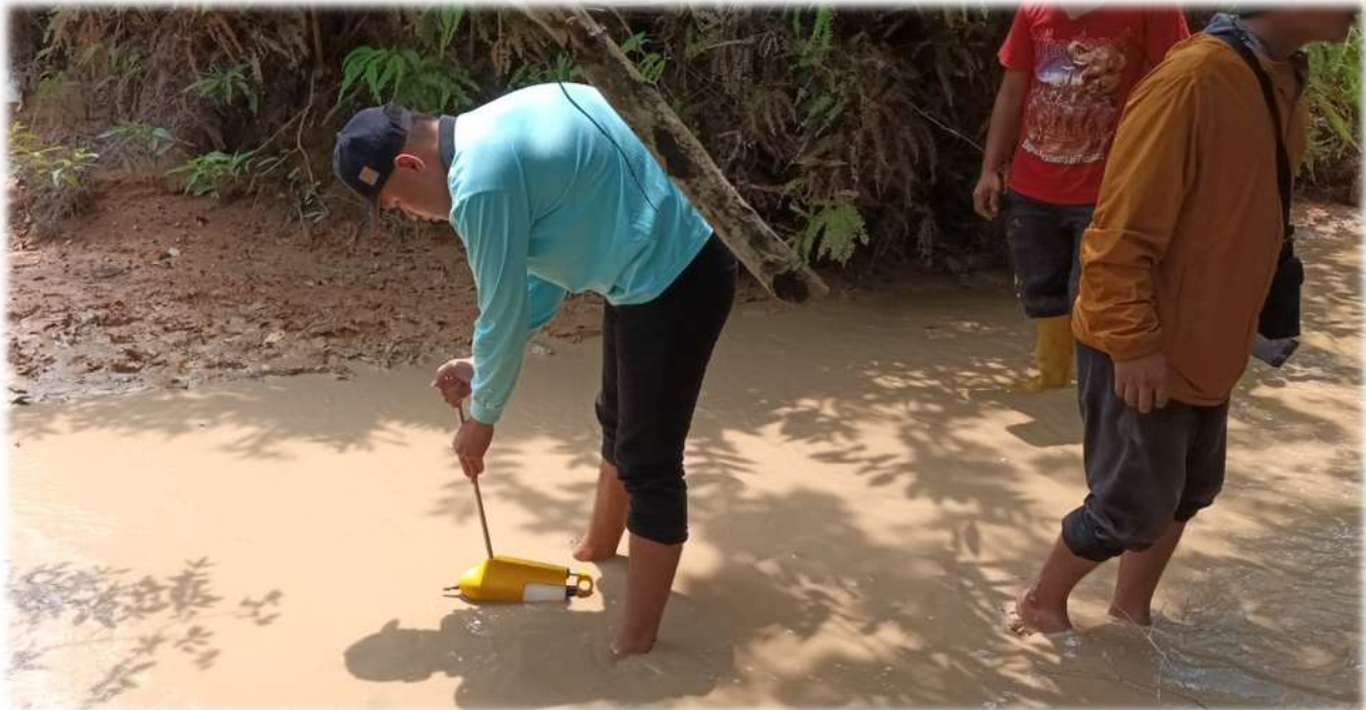
Gambar 10. Pengukuran sedimen tersuspensi di aliran sungai
